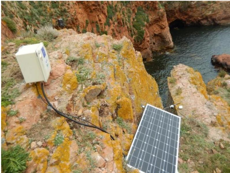
Figure 8: Panneau solaire et modem pour retranscrire la vidéo en direct
