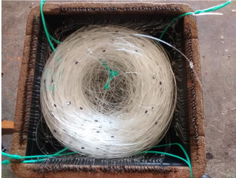
Figura 6_ Celha de palangre demersal com anzóis controlo e modificados.
